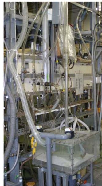
図 12 バブルジェット式エアリフトポンプの試験機
