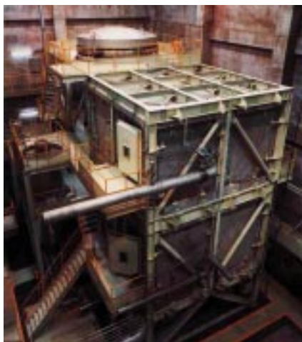
図1 大規模ナトリウム漏洩火災試験装置 図2 燃料からのFP放出挙動試験装置
