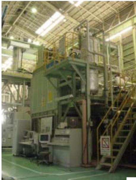
図1 フロン熱流動試験装置（奥に見えるのがX線CT装置）
