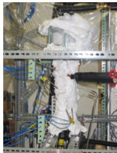
図2 大気圧水 - ステンレス鋼系の実験装置 (中央が断熱材に覆われた伝熱ブロック部)
