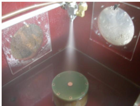
図 6 ミスト冷却実験装置
