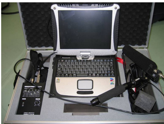
図6 マイクロフォンによる簡易型キャビテーション検知装置
