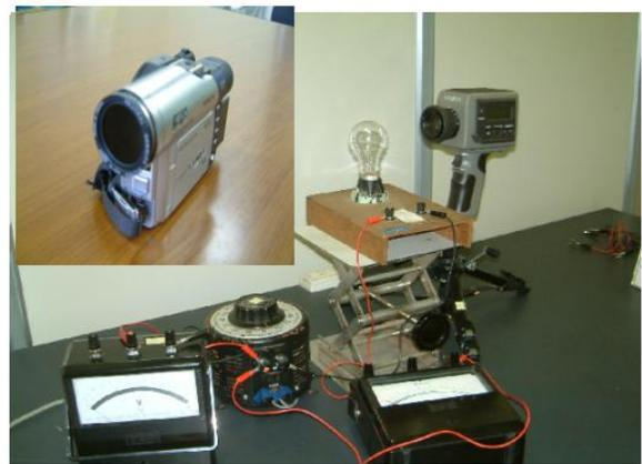
図 1 1 光高温計による熱放射実験装置
