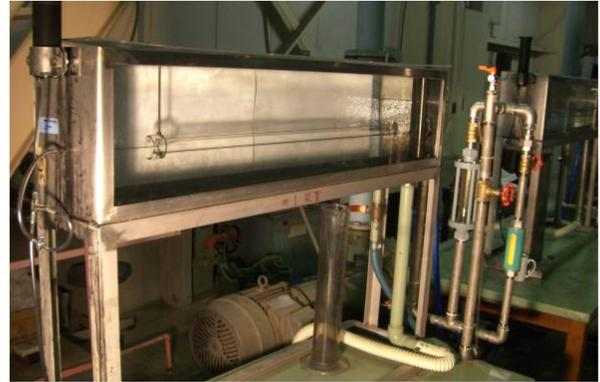
図7 水配管内流れの可視化装置
