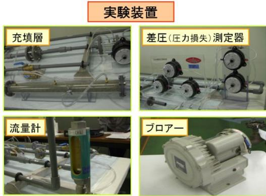
図6 充填層の差圧測定装置
