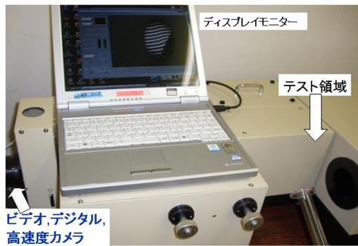
カメラ類は D-file システムに接続し、干渉計からの画像データを収録可能
